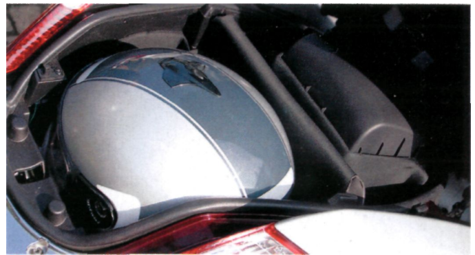
Der voluminöse Luftfilterkasten halbiert den Satelis-Stauraum
